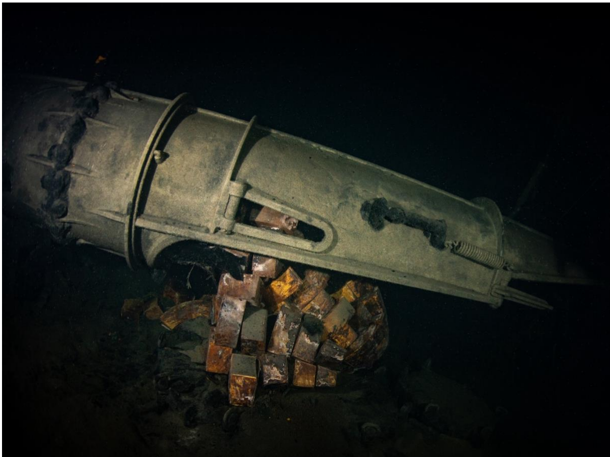
Foto 5. Lagunenud torpeedo peast väljakukkunud lõhkeaine (Harri Laakso)
