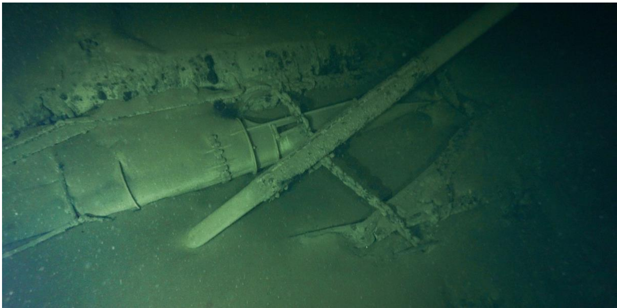
Foto 15. Peaaegu täielikult setetesse mattunud torpeedoaparaat vööris (Ivar Treffner).
