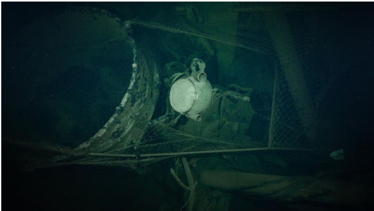
Foto 10. Kompass ja ventilaatori toru, mis on paisatud või traalitud oma algselt kohalt ahtri poole (Ivar Treffner).
